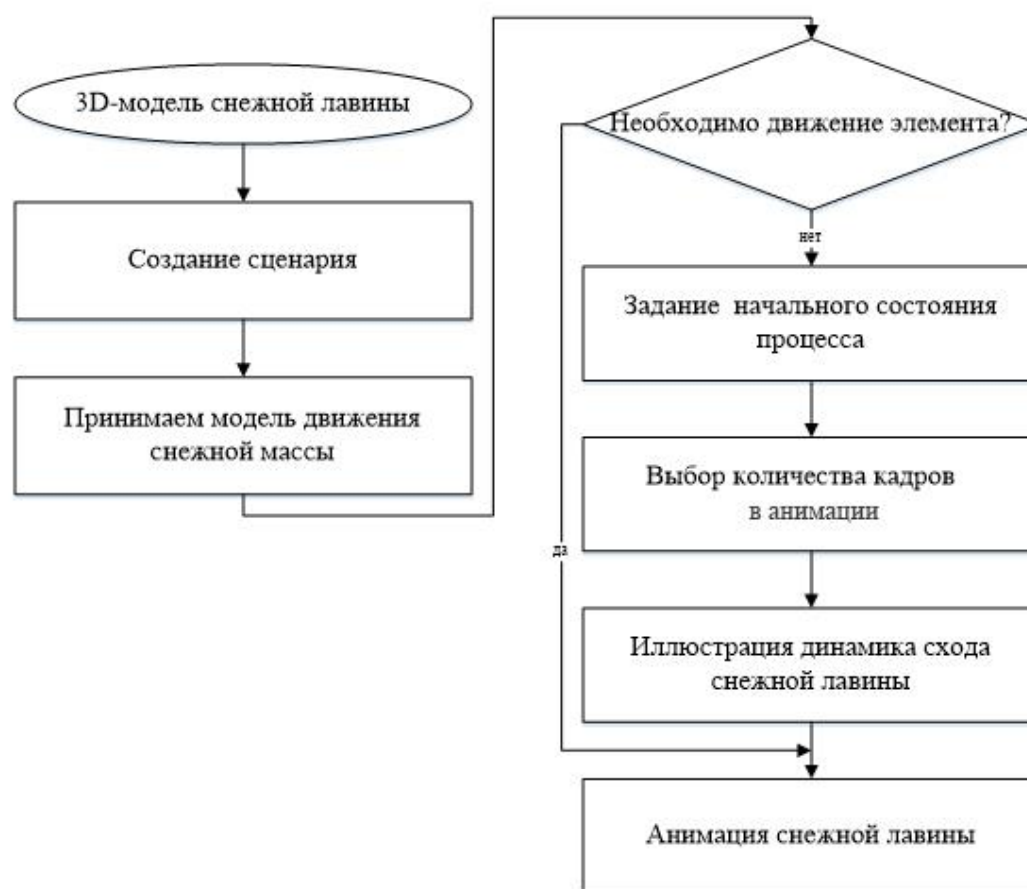
Рис. 3. Схема алгоритма процесса анимации 3D-модели снежной лавины
